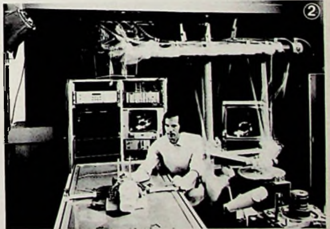
Afb. 2. Voor de elektronische tomosynthese worden een mini-computer, een magnetisch video-schijfgeheugen en een T.V.-geheugenbuis gebruikt in combinatie met een radiologische tomograaf.
